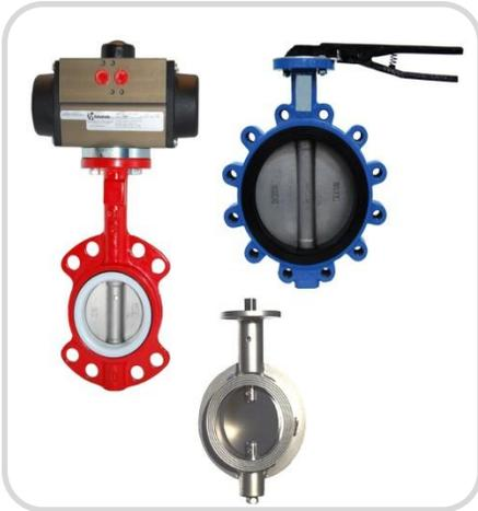
Una válvula de mariposa es un dispositivo para interrumpir o regular el flujo de un fluido en un conducto, aumentando o reduciendo la sección de paso mediante una placa, denominada mariposa, que gira sobre un eje.
